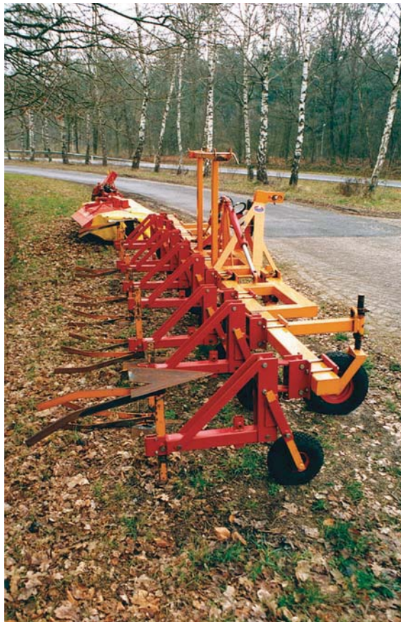
Figuur 3.6 De schoffelmachine is een voorbeeld van mechanische onkruidbestrijding.
